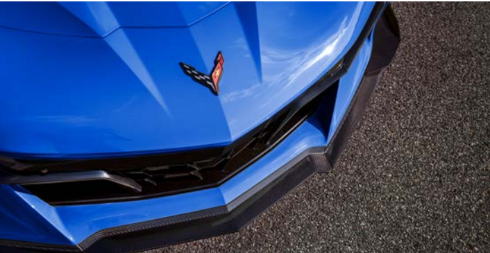
Die Frontpartie wurde entwickelt, um die Kühlanforderungen der Z06 zu optimieren.
